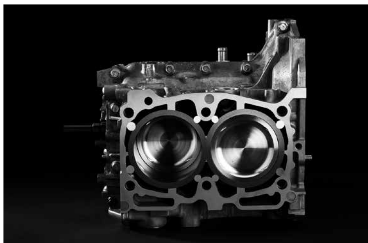
EJ25ブロック補強加工例:ウォータージャケット部周辺にピンを打ち込みます。高負荷時のライナー上部の倒れ込みによるヘッドガスケット抜けを防止する効果が期待できます。他にもいくつか作業実績がございます。詳細はお問い合わせ下さい。
