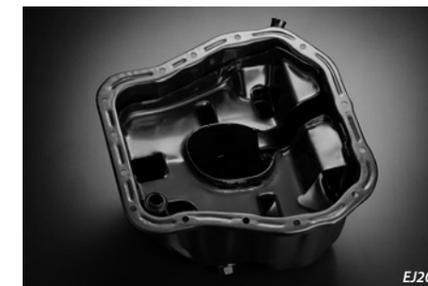
バッフル付きオイルパン・オイルパンバッフルプレート / BAFFLED OIL PAN / OIL PAN BAFFLE PLATE
